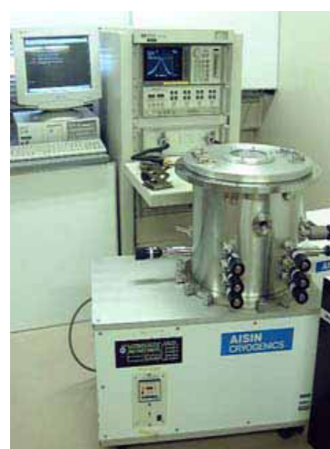
図2 誘電体円柱の \epsilon_r 、 \tan\delta および導体平板の R_s 測定用治具
